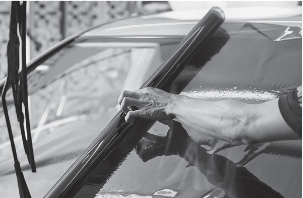
Das Aufbringen von Folien kann Brucheigenschaften der Fahrzeugscheiben negativ beeinflussen
